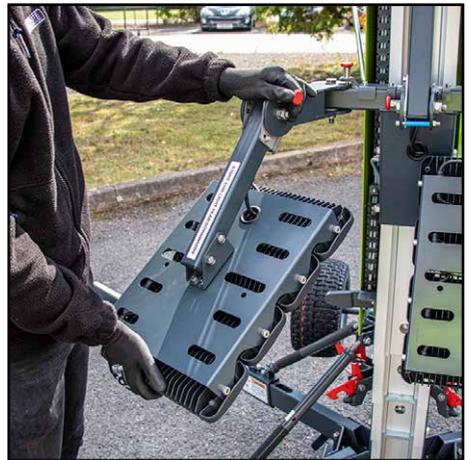
4. El ajuste vertical se realiza tirando de los émbolos de bloqueo situados en el lateral de cada uno de los soportes del cabezal luminoso. Mientras sostiene el cabezal con una mano, utilice la otra para liberar el émbolo. Ajuste el ángulo deseado y suelte el émbolo hasta que se encaje en el orificio.
