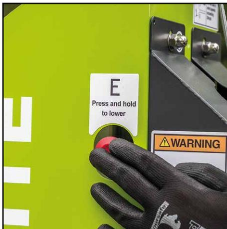
2. Vuelva a tensar el cable de elevación enrollando la manija del cabrestante D ligeramente hacia la derecha para soportar la carga del mástil. Mantenga presionado el botón de seguridad E y gire la manivela del cabrestante D en sentido antihorario para bajar el mástil.
