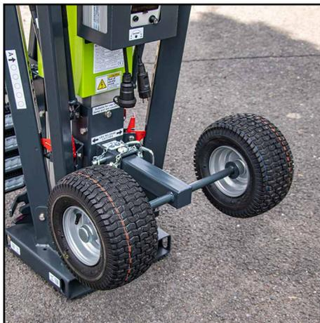
10. Asegúrese de que el juego de ruedas de transporte esté asegurado con el pasador de bloqueo de transporte totalmente encajado, y el pasador de bloqueo del muelle asegurado a través del pasador de bloqueo de transporte para asegurar que no se deslice.
