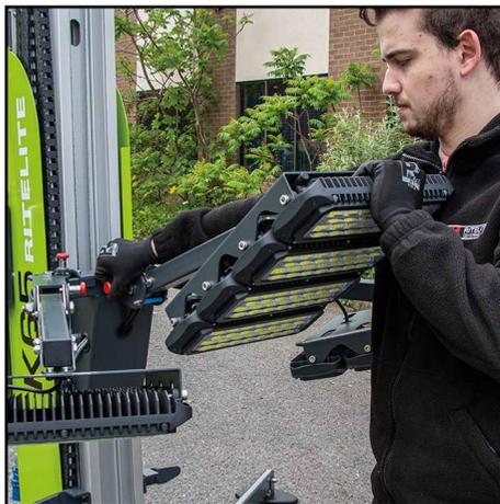
6. Extraiga el pasador de bloqueo vertical del cabezal de luz central y bájelo hasta el mismo ángulo que los cabezales de luz laterales.
