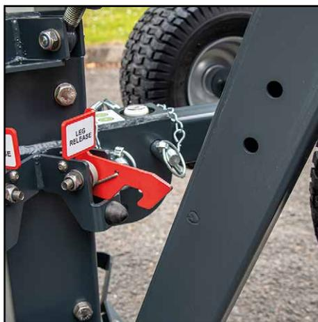
**8.** Empuje la pata hacia el mástil, contra el soporte AV hasta que la palanca de retención roja sostenga la pata.
