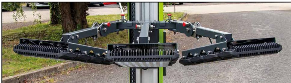
7. Para la configuración estándar de 180°, los cabezales de luz deben configurarse como se muestra arriba.
