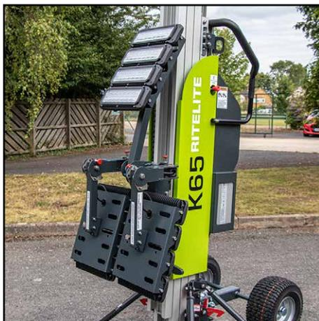
3. Continúe enrollando hasta que los cabezales de luz estén a la altura del pecho y luego deténgase. Ajuste los cabezales de luz a sus posiciones originales de manera que los cabezales de luz exteriores estén girados hacia adentro hasta donde puedan llegar. A continuación, los cabezales exteriores deben estar completamente bajados y el cabezal central completamente levantado.
