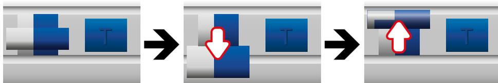
**NOTA** Si el RCBO se ha disparado, el interruptor de encendido no bajará del todo y no pasará a la posición de encendido hasta que se restablezca. Para restablecer el RCBO presione las palancas azul y blanca completamente hacia abajo hasta que hagan clic. Para restablecer la alimentación, presione completamente hacia arriba hasta que encajen.
