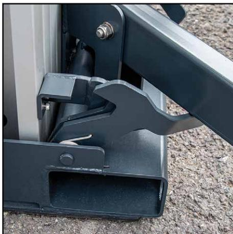
8. Una vez bajadas las 4 patas, los bloqueos de transporte se activarán y permitirán automáticamente la liberación de las secciones del mástil.
