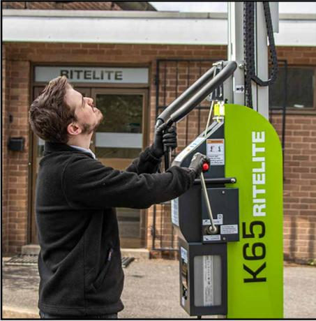
**8.** Continúe elevando el mástil a la altura deseada girando el mango del cabrestante en sentido horario. A medida que sube el mástil, escuchará un chasquido cuando el bloqueo de seguridad se conecta a cada punto de bloqueo.
