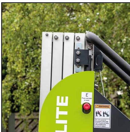
4. Continúe bajando la sección final del mástil hasta que las cabezas de la luz casi toquen el suelo y todas las secciones del mástil estén al ras en la parte superior.
