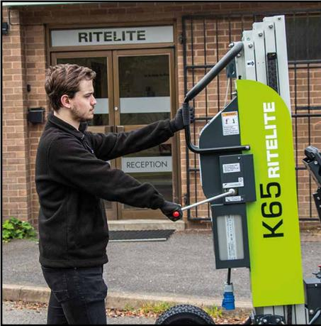
1. Enrolle la manija del cabrestante D en el sentido de las agujas del reloj para levantar las cabezas de la luz lo suficiente como para despejar las trabas de transporte. Deje espacio para configurar y ajustar los cabezales de luz según sea necesario.
