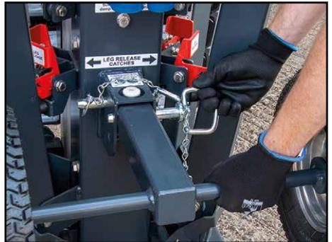
Para bajar el kit de ruedas a la posición de almacenamiento, retire el pasador de bloqueo del muelle, coja el peso de las ruedas y saque el pasador de transporte más cercano a ellas. Baje suavemente las ruedas y vuelva a colocar el pasador de transporte para asegurarlas en la posición bajada.
