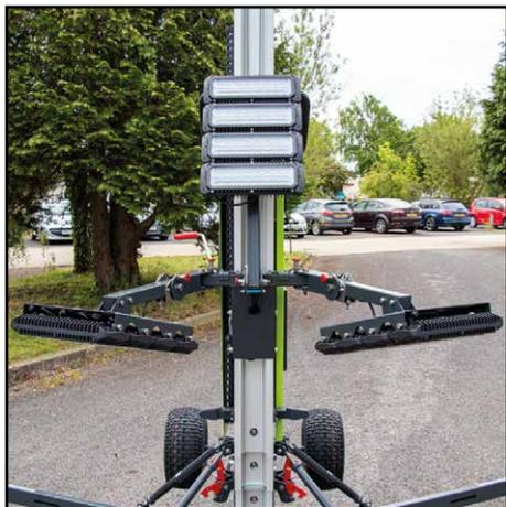
5. Para la configuración estándar de 180°, los cabezales de luz exteriores deben configurarse como se muestra arriba, colocando los pasadores de bloqueo en los orificios correspondientes. Debido a la lente de control del haz, los cabezales de luz deben ajustarse a unos 15° de la horizontal.
