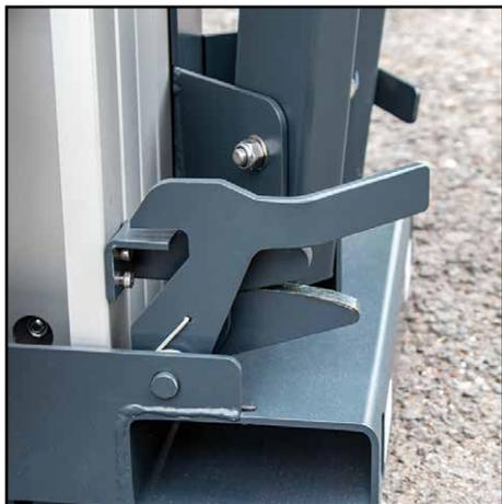
9. Una vez que las 4 patas estén levantadas y bloqueadas, esto mantendrá el mástil seguro y evitará que se levante. **El usuario debe asegurarse de que el mástil esté completamente retraído y que el bloqueo del mástil esté correctamente activado según la imagen.**
