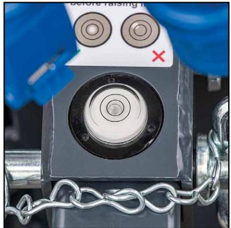
3. Asegúrese de que la base esté nivelada utilizando el nivel de burbuja (la burbuja debe estar dentro del círculo más pequeño). La base está diseñada para soportar el peso de la unidad durante la operación, por lo que es fundamental asegurarse de que el suelo soportará todo el peso de la unidad sin ceder durante el despliegue de esta.
