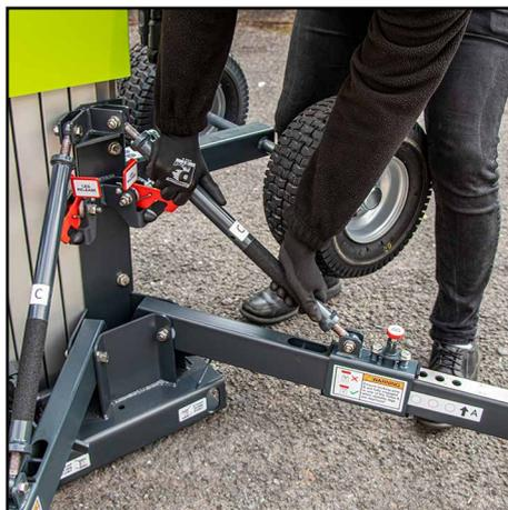
**6.** Asegúrese de que el suelo se haya mantenido firme y de que la unidad se mantendrá estable después de que las patas estén guardadas, si tiene alguna duda solicite la ayuda de otros para sostener o estabilizar el Quad Pod según sea necesario. Levante las patas en cualquier orden para bloquear el mástil en su posición. Gire las barras de bloqueo C en sentido horario hasta que los pasadores de bloqueo B puedan liberarse.
