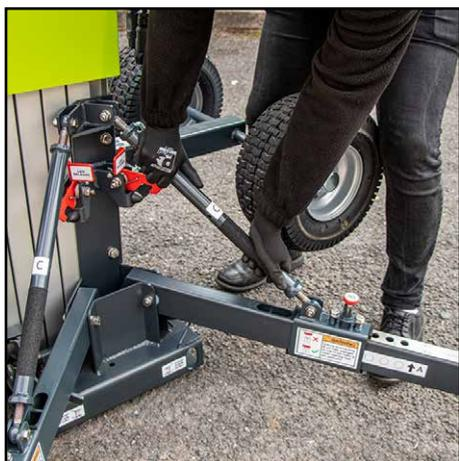
6. Gire la barra de sujeción C y asegúrese de que el pasador de bloqueo B encaje completamente en la pata en uno de los orificios A. Continúe girando la barra de unión hasta que la plataforma de carga haya hecho contacto firme con el suelo. Baje y asegure las otras tres patas de la misma manera, luego verifique nuevamente que las cuatro plataformas de carga estén seguras.
