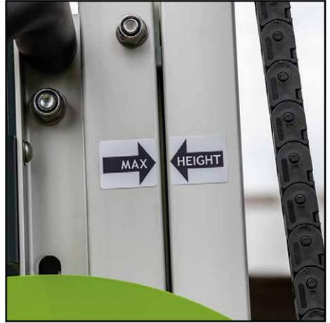
**9.** Cuando el mástil esté a la altura deseada, deje de enrollar. Ahora enrolle la manija en la dirección opuesta ligeramente hasta que el bloqueo de seguridad del mástil E encaje. La carga ahora debe ser soportada por las cerraduras de seguridad, así como por el cable del cabrestante.
