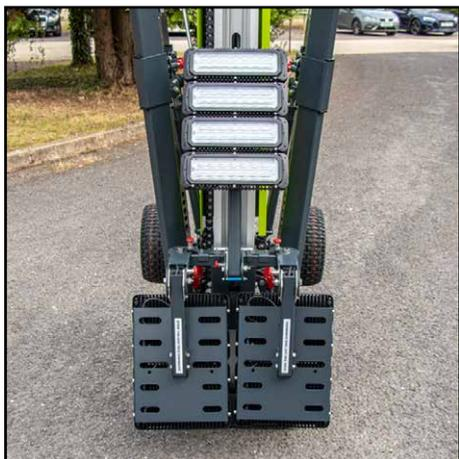
**5.** Asegúrese de que las cabezas de la luz estén lo suficientemente juntas como para permitir que las patas se eleven sin obstrucción.
