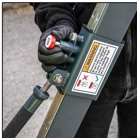
**7.** Tire y sostenga los pasadores B mientras levanta las patas y regresa a su palanca de retención en el mástil.
