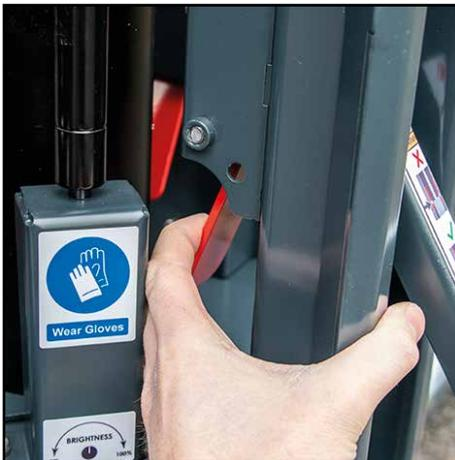
7. Tire de la palanca roja del carro de la pata hacia usted para liberar el mecanismo de bloqueo del carro de la pata. Manténgase en posición y levante la pata.
