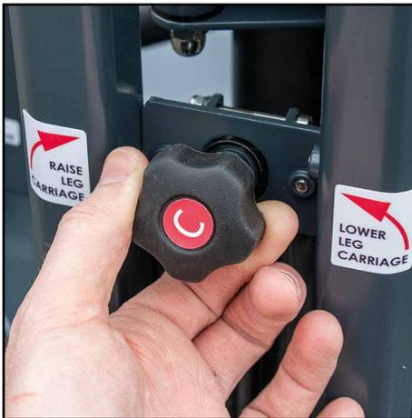
6. Gire las perillas para ajustar el carro de la pata. La pata debe hacer clic para que no suba cuando se tira hacia arriba. Luego ajuste la perilla hasta que se aplique presión al suelo, el LED rojo desapareciera cuando se aplica suficiente presión.
