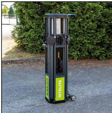
1. Empuje la K45 360 a una posición vertical sobre su base en un suelo firme y horizontal, lejos de obstáculos aéreos como árboles o líneas eléctricas. Coloque la unidad de modo que las cuatro patas estabilizadoras puede ubicarse en terreno firme cuando se despliegue.
