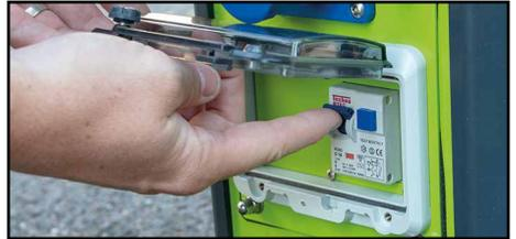
5. Conecte el cable de alimentación y encienda el interruptor de alimentación principal. Un LED de estabilidad de la pata debe iluminarse, indicando que la pata no está ajustada correctamente para sostener el producto de forma segura.
