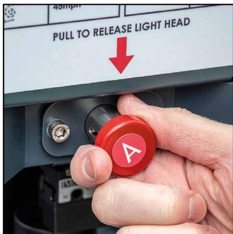
2. Tire del bloqueo de tránsito del cabezal de luz.
