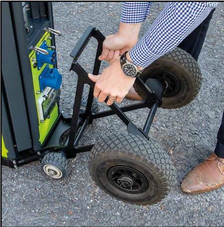
1. Con la K45 parada sobre su base, coloque los ganchos inferiores del kit de ruedas sobre el eje de la K45.
