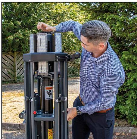
4. Empujar los cabezales de luz hacia abajo del marco hasta que el bloqueo de transporte haga clic y los mantenga en su posición.
