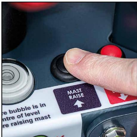
1. Presione el botón "elevar el mástil" una vez para elevar el mástil hasta que los cabezales de luz estén por encima de la parte superior de la unidad, si aún no lo están, luego presione el botón rojo "detener el mástil" con una presión rápida para detener.
