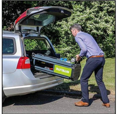
Utilice las técnicas de elevación correctas para cargar la K45 360 en el vehículo de transporte al levantar con dos personas, usar el rodillo como punto de pivote para controlar el peso y ayudar a cargar.
