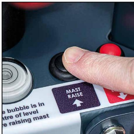
3. Presione el botón “Levantear mástil”. El mástil ahora se elevará automáticamente a su altura máxima. Es normal que el mástil se detenga durante varios segundos a medida que aumenta la presión del aire para elevar cada sección de este.
