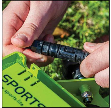
**10.** Drücken Sie den Stecker ein, bis er einrastet. Dies gewährleistet eine gute wasserfeste Verbindung. Je nach Batteriemodell kann sich das Licht einschalten, sobald diese Verbindung hergestellt ist.
