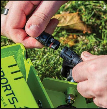
**9.** Verbinden Sie das Batteriekabel mit dem Lichtkopfkabel, es passt nur in eine Richtung.
