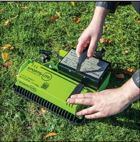
**7.** Setzen Sie den Akku in die Halterung ein. Verwenden Sie zum Anheben der Batterie nur den mitgelieferten Griff, niemals das Batteriekabel.
