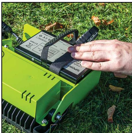
7. Wenn Sie den Akku aus dem Leuchtenkopf entfernen möchten, ziehen Sie den Klettstreifen nach oben.
