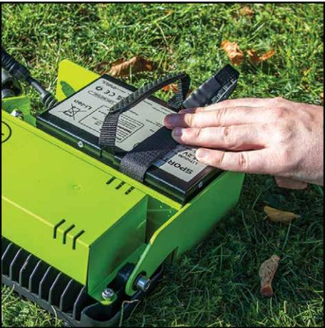
**8.** Sichern Sie den Akku mit dem Klettband. Vergewissern Sie sich, dass der Klettverschluss fest sitzt, bevor Sie das Stativ aufsetzen.
