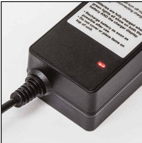
**3.** Nach dem Einschalten der Netzstromversorgung des Ladegeräts leuchtet die Anzeileuchte des Ladegeräts rot auf. Der Ladezustand (SOC) kann auf der Batterie selbst abgelesen werden, während sie aufgeladen wird. Beachten Sie, dass Sie die Batterieanzeige möglicherweise mit der runden Taste an der Batterie einschalten müssen.
