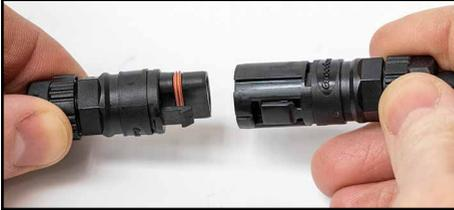
**1.** Vergewissern Sie sich, dass die Batterie ausgeschaltet ist, und schließen Sie dann Ihren Batteriekuppler an den Ausgangsstecker des Ladegeräts an.
