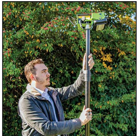
**16.** Halten Sie das untere Mastteil mit einer Hand fest und schieben Sie das obere Mastteil schrittweise nach oben. Ein Sicherheitsstift rastet beim Anheben in die Löcher des Mastes ein, so dass dieser nur nach oben bewegt werden kann. Sobald die volle Höhe erreicht ist, senken Sie ihn vorsichtig ein Stück ab, bis der Sicherheitsstift in das oberste Loch einrastet.
