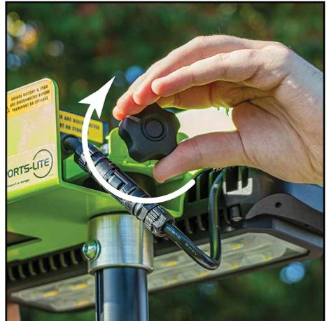
**12.** Ziehen Sie den Knopf des Lichtkopfes durch Drehen im Uhrzeigersinn fest.
