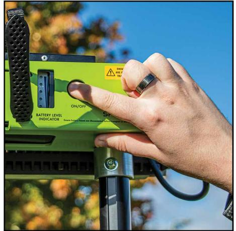
**14.** Drücken Sie die Taste auf der Rückseite des Geräts, um das Gerät einzuschalten. Der Lichtkopf leuchtet nun auf. Gleichzeitig leuchtet die Batteriestandsanzeige auf und leuchtet während des Betriebs des Kopfes weiter, um den verbleibenden Batteriestand anzuzeigen (dieser Knopfdruck ist bei Versionen, bei denen die Anzeige sofort nach dem Anschließen aufleuchtet, nicht erforderlich).
