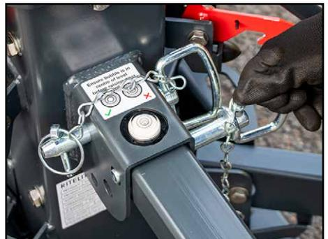
Um den Radsatz in die Aufbewahrungssposition abzusenken, entfernen Sie den Federsicherungsstift, nehmen Sie das Gewicht der Räder und ziehen Sie den Transportstift heraus, der den Rädern am nächsten ist. Senken Sie die Räder vorsichtig ab und setzen Sie den Transportstift wieder ein, um sie in der abgesenkten Position zu sichern.
