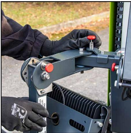
3. Stellen Sie die Lichtköpfe, beginnend mit den seitlichen Halterungen, in den gewünschten Winkeln ein. Die horizontale Einstellung erfolgt durch Anheben des Verriegelungsstifts an der Oberseite der Halterung des Hauptlichtkopfes. Drehen Sie entweder den linken oder den rechten Lichtkopf in die gewünschte Position, während Sie ihn hochhalten.
