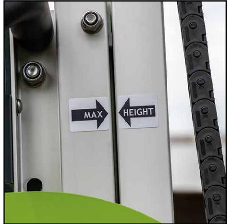
**8.** Wenn sich der Mast in der gewünschten Höhe befindet, stoppen Sie das Drehen des Windenhebels. Drehen Sie nun den Hebel leicht in die entgegengesetzte Richtung, bis die Mastsicherung E einrastet. Die Last sollte nun von den Sicherheitsverriegelungsstiften sowie dem Windenseil getragen werden.
