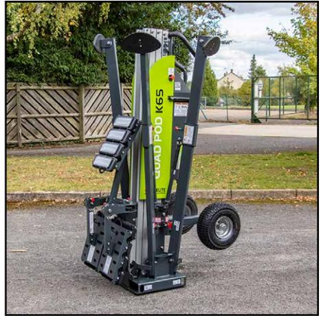
1. Schieben Sie den Mast auf festem, waagrechttem Untergrund in senkrechter Position auf seine Grundplatte, weg von Hindernissen wie Bäumen oder Stromleitungen. Auf rutschigem oder unebenem Gelände wird empfohlen, das Produkt immer zu zweit zu manövrieren. Stellen Sie das Gerät so auf, dass alle vier Stützbeine beim Ausfahren auf festem Boden stehen.
