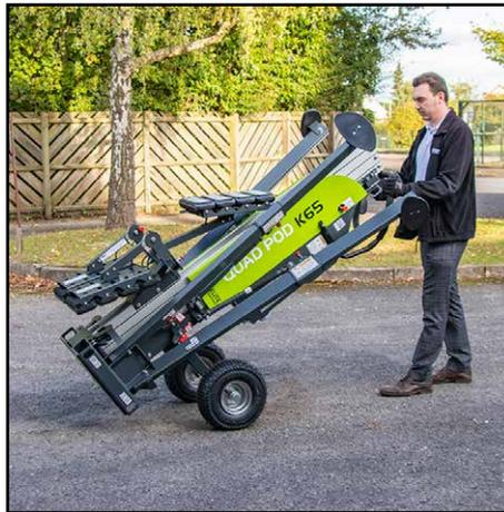
11. Fassen Sie die Griffe am Mast und halten Sie das Gewicht des Quad Pods, während Sie ihn zum Transport vorsichtig auf die Räder absenken. Auf rutschigem oder unebenem Gelände wird empfohlen, dass das Produkt stets von zwei Personen manövriert wird.
