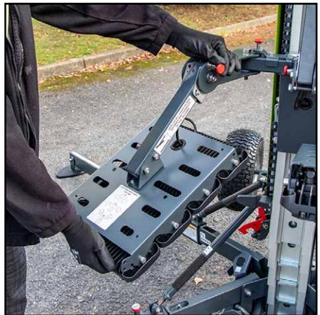
4. Die vertikale Einstellung erfolgt durch Herausziehen des Sicherungsstifts an der Seite der einzelnen Lichtkopfhalterungen. Stützen Sie den Leuchtenkopf mit einer Hand ab und lösen Sie den Sicherungsstift mit der anderen Hand. Richten Sie die Halterungsstange so aus, dass sie parallel zum Boden ist. Lassen Sie den Sicherungsstift los und vergewissern Sie sich, dass er in der Aufnahmebohrung einrastet.
