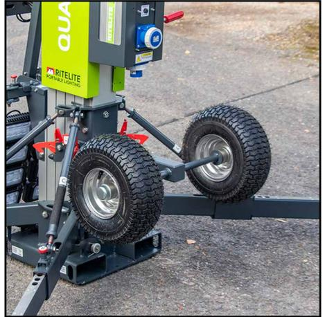
10. Vergewissern Sie sich, dass der Transportradsatz mit dem Transportsicherungsstift vollständig eingerastet ist und der Federsicherungsstift durch den Transportsicherungsstift gesichert ist, damit er nicht herausrutschen kann.
