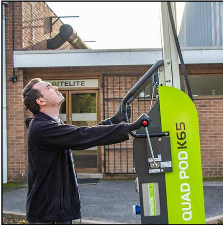
**7.** Heben Sie den Mast weiter auf die gewünschte Höhe an, indem Sie den Windenhebel im Uhrzeigersinn drehen. Wenn Sie den Mast anheben, hören Sie ein Klickgeräusch, wenn die doppelten Sicherungsstifte in die Schlitze an der Seite des ersten beweglichen Mastabschnitts eingreifen.
