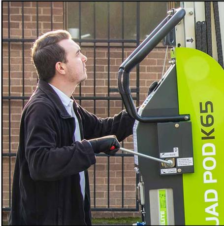
1. Windenhebel D im Uhrzeigersinn drehen, um die Leuchtenköpfe so weit anzuheben, dass die Transportsicherungen freigegeben werden. Lassen Sie Platz, damit die Lichtköpfe nach Bedarf eingerichtet und eingestellt werden können.
