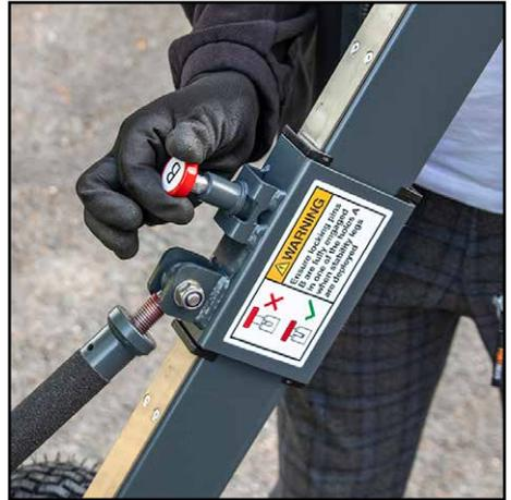
5. Ziehen Sie den Sicherungsstift B heraus, halten Sie ihn fest und senken Sie das Bein auf den Boden. Lassen Sie den Sicherungsstift los.
