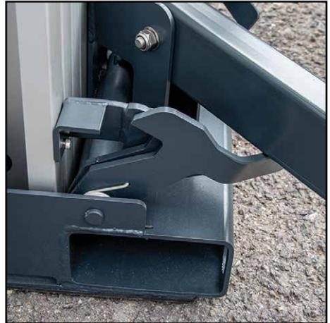
8. Sobald alle 4 Stützbeine abgesenkt sind, werden die Transportsicherungen aktiviert und geben die Mastteile automatisch frei, sodass der Mast angehoben werden kann.
