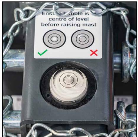
3. Stellen Sie sicher, dass die Basiseinheit mit der Wasserwaage waagrecht ausgerichtet ist (die Wasserwaage sollte sich innerhalb des kleinsten Kreises befinden). Die Basiseinheit ist so konstruiert, dass sie während des Betriebs das Gewicht der Einheit trägt. Es ist daher wichtig, dass der Boden das gesamte Gewicht des K50 / 65 tragen kann, ohne während des Einsatzes der Einheit nachzulassen.
