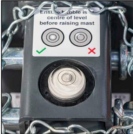
7. Sobald alle Stützbeine fest auf dem Boden stehen und die Stifte eingerastet sind, überprüfen Sie die Wasserwaage erneut, um sicherzustellen, dass der Mast noch senkrecht steht. Die Wasserwaage sollte sich innerhalb des kleinsten Kreises befinden. Wenn dies nicht der Fall ist, können Sie die Einstellen durch drehen der Verbindungsstangen C vornehmen. Überprüfen Sie erneut, ob die Stützbeine und der Mast fest sitzen, wenn Sie Änderungen vornehmen.
