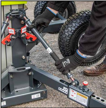
6. Drehen Sie die Zugstange C und vergewissern Sie sich, dass der Sicherungsstift B vollständig in eines der Löcher A im Bein einrastet. Drehen Sie die Zugstange weiter, bis die Fußplatten festen Bodenkontakt haben. Senken und sichern Sie die anderen drei Beine auf die gleiche Weise und überprüfen Sie dann erneut, ob alle vier Fußplatten sicher sind.
