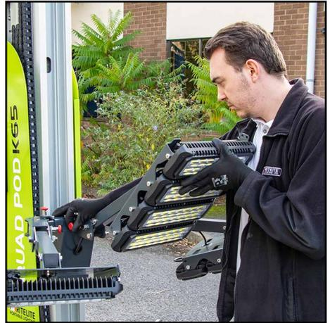
6. Ziehen Sie den vertikalen Sicherungstift für den mittleren Lichtkopf heraus und senken Sie ihn in die gleiche Position wie die seitlichen Lichtköpfe. Siehe Einstellungspositionen auf Seite 22.
