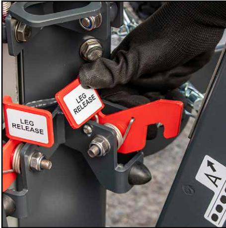
4. Zum Absenken der Stützbeine Druck auf das Bein in Richtung Mast ausüben (dadurch kann die Entriegelungssperre betätigt werden) und die Sperrklinke drücken.
