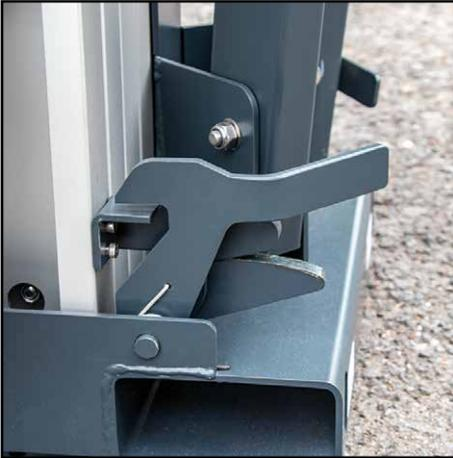
9. Sobald alle 4 Stützbeine angehoben und verriegelt sind, wird der Mast sicher gehalten und verhindert, dass er angehoben wird. **Der Benutzer muss sicherstellen, dass der Mast vollständig eingefahren ist und dass die Mastverriegelung wie auf dem Bild gezeigt korrekt eingerastet ist.**
