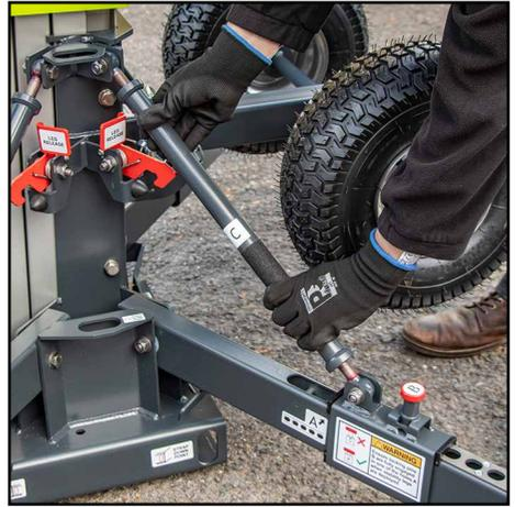
6. Vergewissern Sie sich, dass der Boden fest ist und das Gerät nach dem Verstauen der Beine stabil steht. Bitten Sie im Zweifelsfall andere Personen, den Quad Pod nach Bedarf abzustützen oder zu stabilisieren. Hinweis: Sobald ein Stützbein angehoben wurde, wird der Mast automatisch in seiner Transportposition verriegelt. Zugstangen C im Uhrzeigersinn drehen, bis die Sicherungsstifte B herausgezogen werden können.
