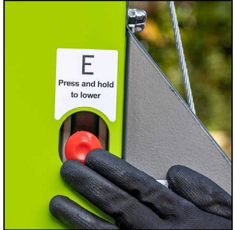
2. Spannen Sie das Hubseil nach, indem Sie den Windenhebel D leicht im Uhrzeigersinn drehen, um die Last aufzunehmen. Halten Sie den Sicherheitsknopf E gedrückt und drehen Sie den Windenhebel D gegen den Uhrzeigersinn, um den Mast abzusenken.
