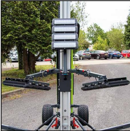
5. Für eine gerichtete Beleuchtung von 180° sollten die äußeren Lichtköpfe wie oben gezeigt eingestellt werden, indem die Sicherungstifte in die entsprechenden Löcher gesteckt werden. Aufgrund der Strahlsteuerungslinse müssen die Lichtköpfe auf ca. 15° aus der Horizontalen eingestellt werden mit den Halterungsstangen parallel zum Boden.
